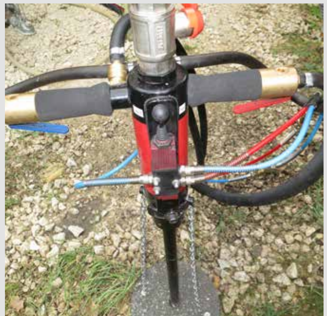
Die Injektionseinheit mit Joystick injection unit with joystick
